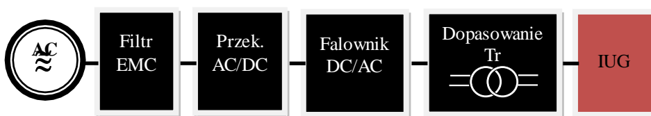
Rys. 1.3. Typowy schemat konwersji energii we współczesnych generatorach do nagrzewania indukcyjnego
